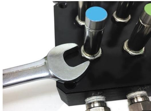
外したパイプの中にロッドとスプリングが入っているので分解します。(向きを確認願います)
