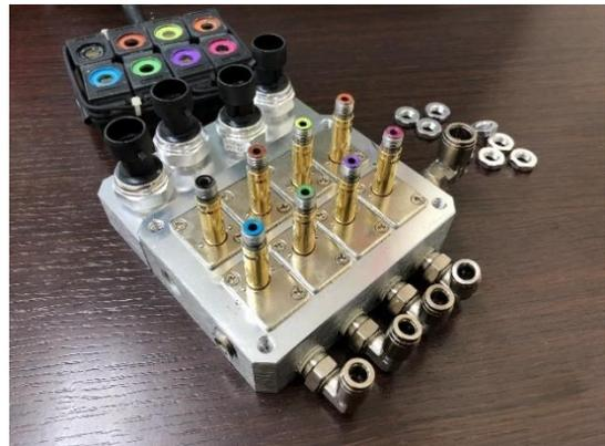
前 4 個が給気(上げ)側、奥 4 個が排気(下げ) 側です。 不具合箇所の電磁弁をドライバーで外します。
