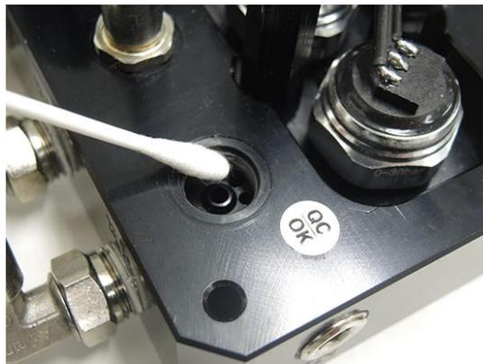
掃除を終えたら、基板本体のカプラーと電磁弁のマグネットカプラーが重ならないよう、マグネットを回して干渉しないよう十分注意して基盤を装着してください。
